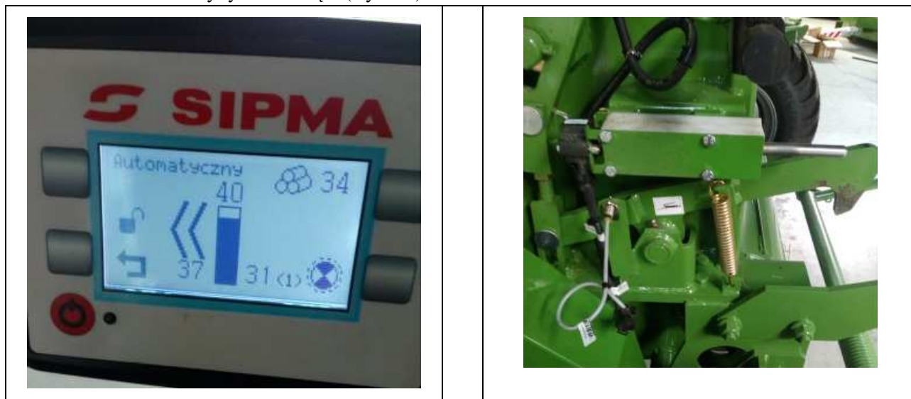
Rys.56 EKRAN PRACY I WIDOK CZUJNIKA RÓWNOMIERNOŚCI WYPEŁNIENIA
